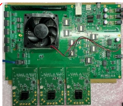
FPGA1個にADC/DACを3個接続
