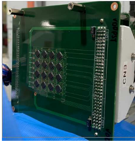
図 2.12: 中性子照射試験における 32 チップの同時測定. 16 チップを実装した DUT ボードを 2 枚を重ねて同時に照射した.
