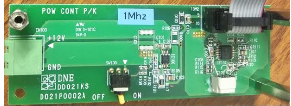
図4 実装した 48V/12V 降圧コンバータ
