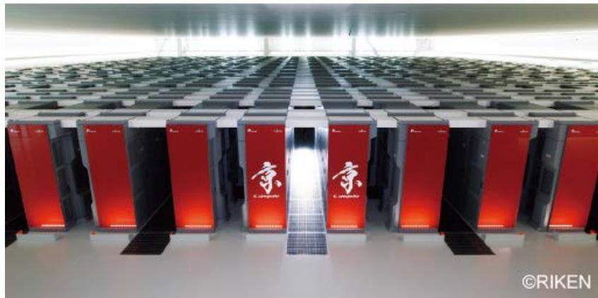
「88,128個のCPUなどから構成されるシステム全体が29時間28分にわたって無故障で動作したことは、世界最大級の超大規模システムの安定性を実証することになりました。」
