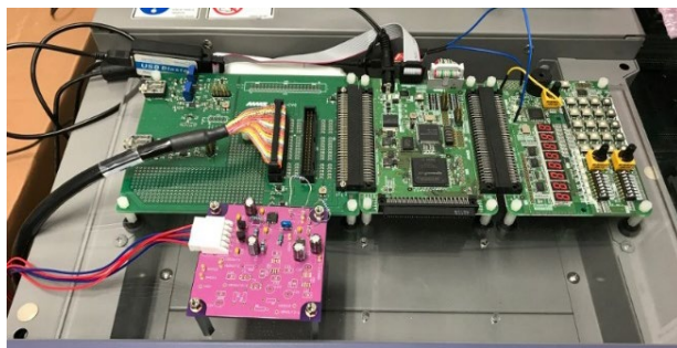
マイコンとFPGAを使った 微細LSIの長期信頼性測定系
